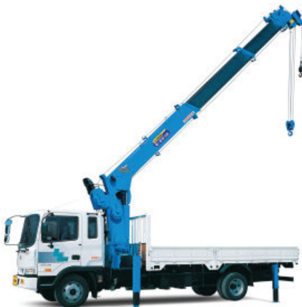
Cầu tự hành lắp trên xe tải cần ống lồng (6T-17.5T)
